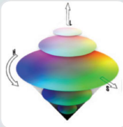
Imagem mostra pontos de vista do HSL: a saturação e a luminosidade variam de 0% a 100% e indicam o quão densa é a intensidade da cor (S) e a variação de claridade (L)
